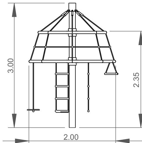
Utilização do equipamento sujeito a condições vigiadas; Zona de segurança: Área mínima requerida pela norma EN 1176-1
