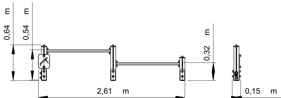
Utilização do equipamento sujeito a condições vigiadas; Zona de segurança: Área mínima requerida pela norma EN 16630
