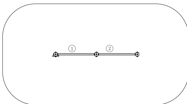
Utilização do equipamento sujeito a condições vigiadas; Zona de segurança: Área mínima requerida pela norma EN 16630
