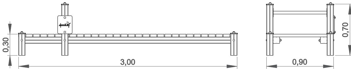
Utilização do equipamento sujeito a condições vigiadas; Zona de segurança: Área mínima requerida pela norma EN 1176-1,6
