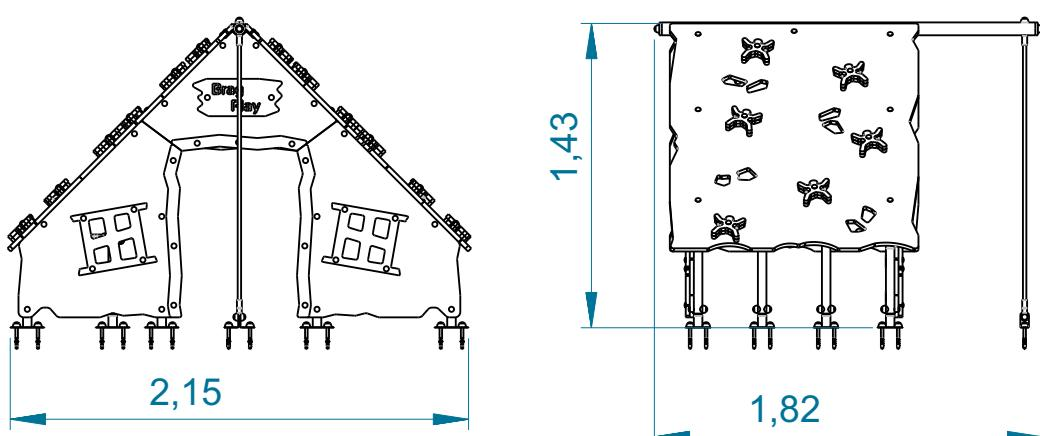
Utilização do equipamento sujeito a condições vigiadas; Zona de segurança: Área mínima requerida pela norma EN 1176-1
