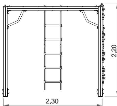
Utilização do equipamento sujeito a condições vigiadas; Zona de segurança: Área mínima requerida pela norma EN 1176-1,6
