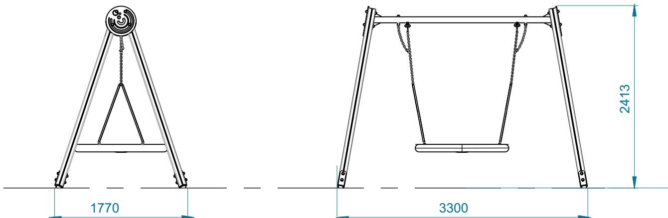
Utilização do equipamento sujeito a condições vigiadas; Zona de segurança: Área mínima requerida pela norma EN 1176-1,2
