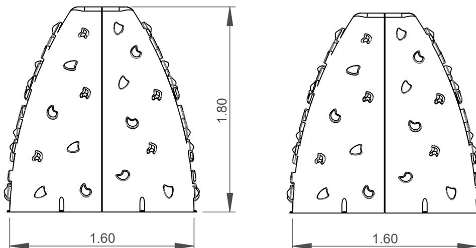
Utilização do equipamento sujeito a condições vigiadas; Zona de segurança: Área mínima requerida pela norma EN 1176-1,6
