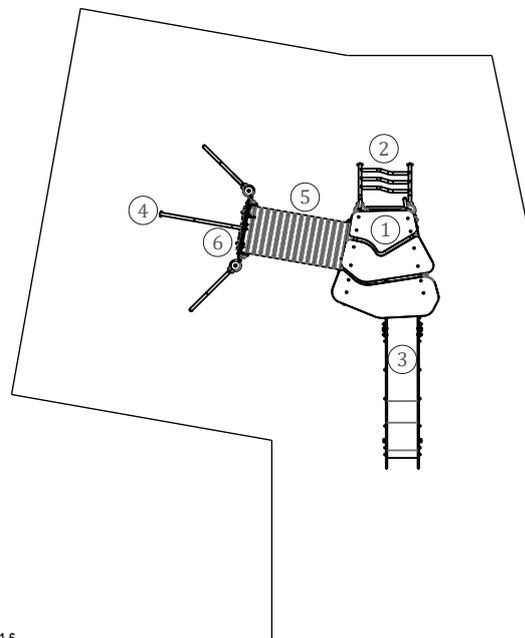
Utilização do equipamento sujeito a condições vigiadas; Zona de segurança: Área mínima requerida pela norma EN 1176-1,6
