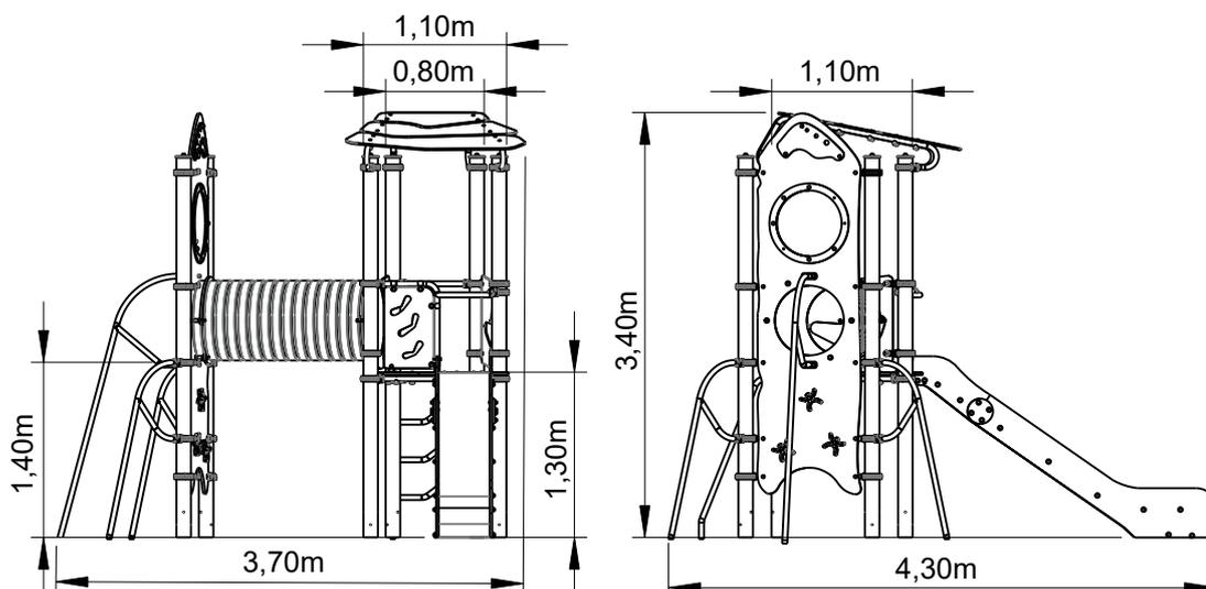
Utilização do equipamento sujeito a condições vigiadas; Zona de segurança: Área mínima requerida pela norma EN 1176-1,6
