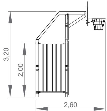
Utilização do equipamento sujeito a condições vigiadas; Zona de segurança: Área mínima requerida pela norma EN 1176-1,6
