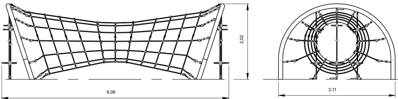
Utilização do equipamento sujeito a condições vigiadas; Zona de segurança: Área mínima requerida pela norma EN 1176-1,6
