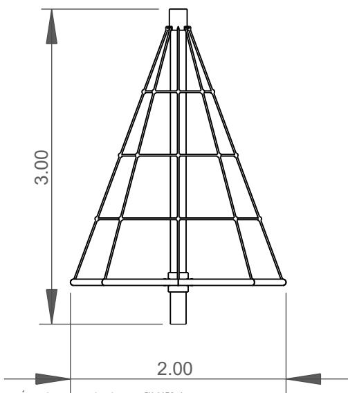
Utilização do equipamento sujeito a condições vigiadas; Zona de segurança: Área mínima requerida pela norma EN 1176-1
