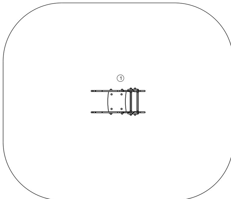
Boneco de mola com corpo em forma de um porco na cor rosa, 1 assento com apoio de pés incorporado, 2 apoios ergonómicos de mãos, apoiado em mola helicoidal. Fixação ao solo com o chumbador ref.<sup>a</sup> 005049 (adquirido à parte, não incluído no preço).
